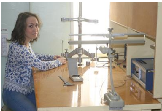
Установка для определения модуля сдвига и модуля кручения стержня
