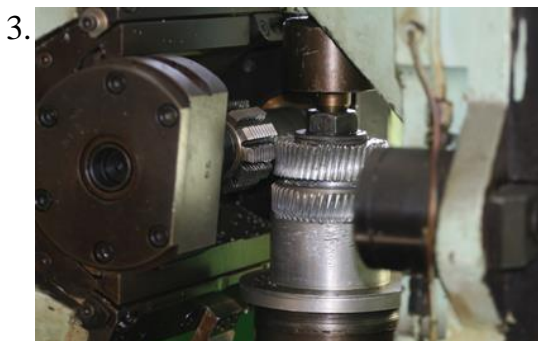
Станок зубофрезерный 5K310 (конструкция и наладка зубофрезерного станка)
