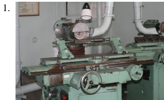
Специальный заточной станок 3А64М (заточка развертки)
