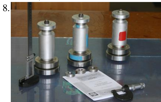
Комплект специальных сборочных узлов и средств измерения (решение сборочных размерных цепей методом регулирования)
