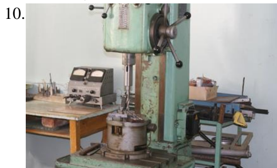
Вертикально-сверлильный станок 2А125 (определение силы резания при сверлении)
