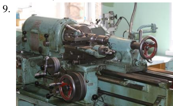
Токарно-винторезный станок ТВ320 (определение шероховатости при точении)
