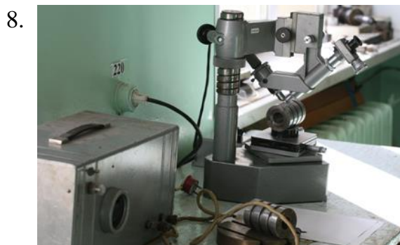
Универсальный микроскоп МИС-11 (определение шероховатости при точении)
