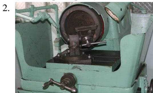
Специальный заточной станок 3Б625 (заточка резца)
