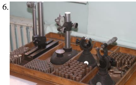
Комплект специальных деталей и средств измерения (статистические методы исследования точности обработки деталей)
