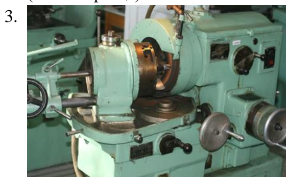
Специальный заточной станок 3659М (заточка сверла)
