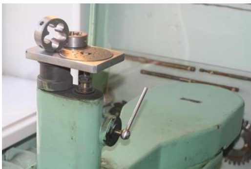
Специальный заточной станок 27А (заточка резьбонарезной плашки)
