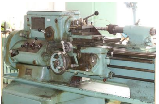
Токарно-винторезный станок 1А616 (исследование температуры в зоне резания)
