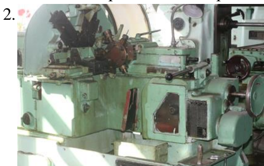
Станок токарный автомат 1B125 (конструкция и наладка токарного автомата)
