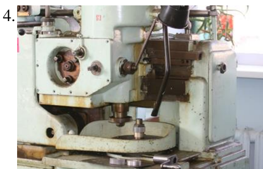
Станок зубодолбежный 5B12 (конструкция и наладка зубодолбежного станка)
