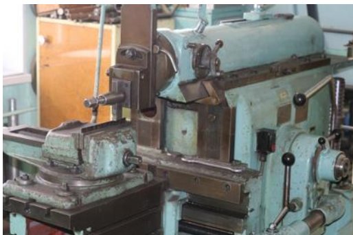
Станок поперечно-строгальный 7Б35. (определение усадки стружки)
