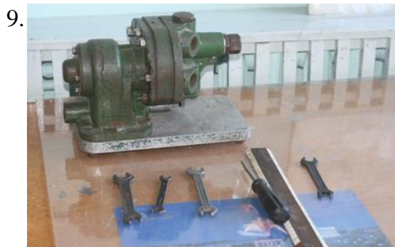
Специальный узел масляного насоса (построение технологической схемы сборки)
