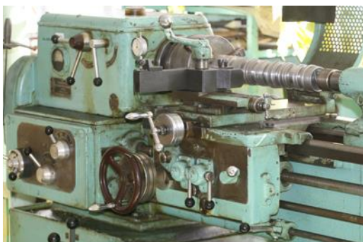
Токарно-винторезный станок 1Е61МТ (определение силы резания при точении)
