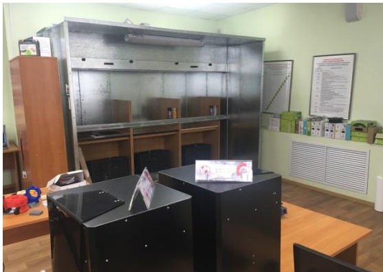
Окрасочная камера с сухой фильтрацией модель D3000
