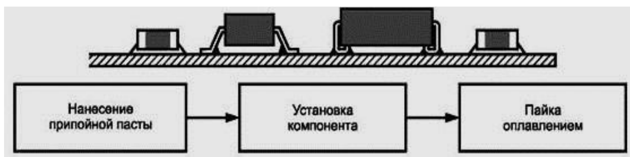
Рисунок 1 - Односторонний печатный узел с поверхностным монтажом (ПМ) компонентов поверхностного монтажа (КПМ). Пайка только оплавлением
