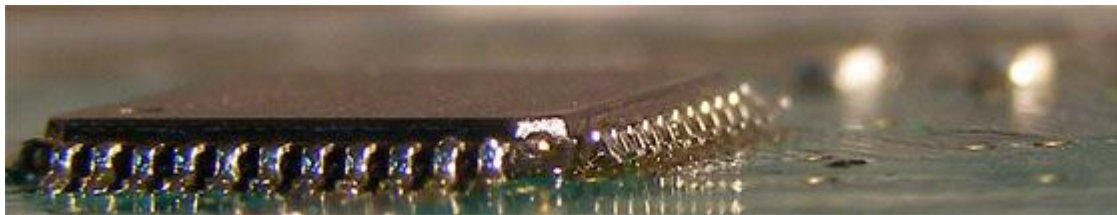
Рисунок 1. В результате - ряд приподнятых над платой выводов.
